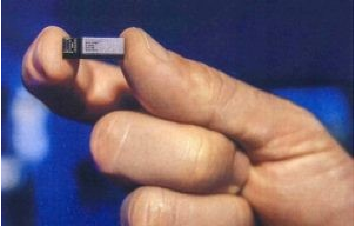
Slika 4: Model Kvalkom-ove (eng. Qualcomm ) združene-antene milimetarskih talasa za 5G pametni telefon. Ima četiri antene, koje mogu precizno da usmere ka najbližoj 5G stanici. Telefoni će imati 4 ovakva modula, to jest šesnaest antena. 4
